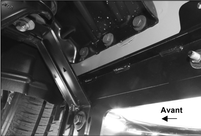
(Fig. 12) Illustration des supports avant côté passager fixés au rebord du tube de la barre de protection
