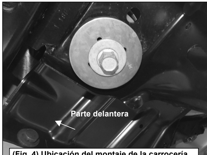
(Fig. 4) Ubicación del montaje de la carrocería delantera del lado del pasajero
